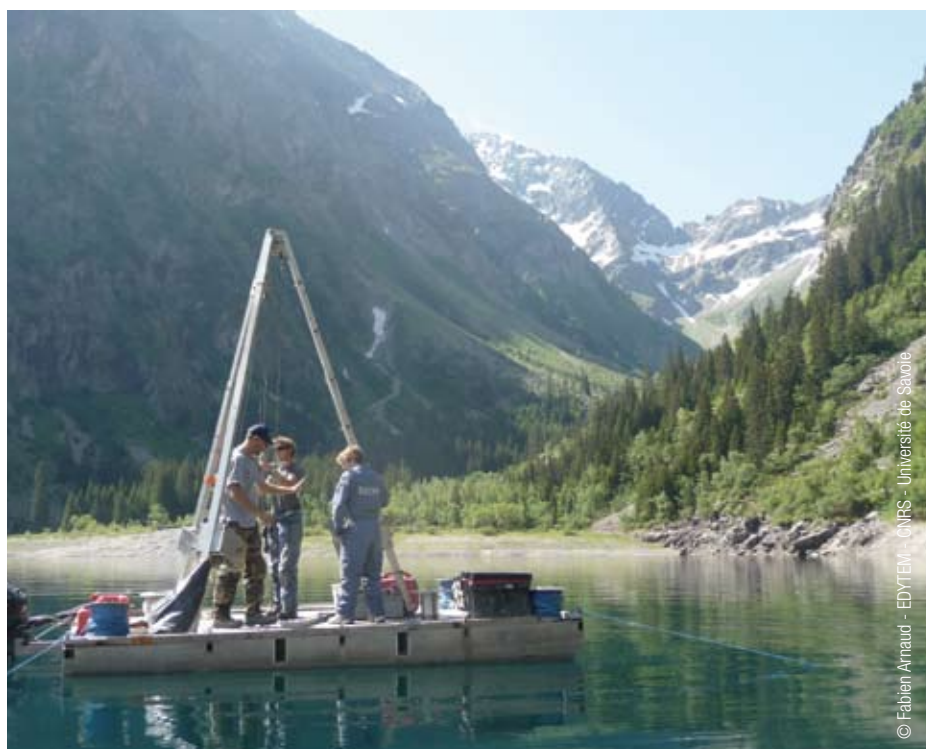
Réalisation d'une carotte de sédiments sur le lac Lauvitel par l'équipe du laboratoire EDYTEM
