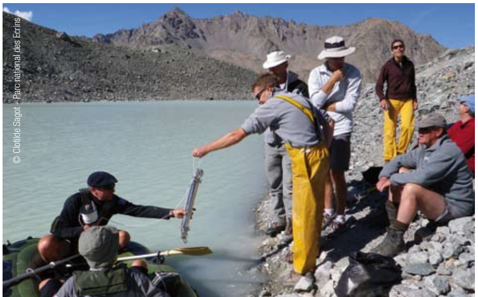
Réalisation de mesures physiques grâce à une sonde multiparamétrique
